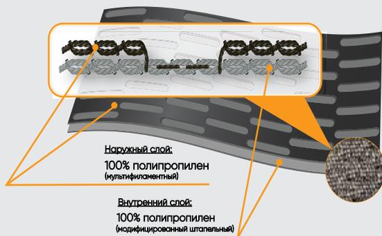
“Использование гидрофобных полипропиленовых пряжи на изнаночной стороне и нитей на лицевой стороне совместно со структурой полотна обеспечивает повышение его теплозащитных свойств. Существенным отличием является отсутствие пилинга на лицевой стороне.”
